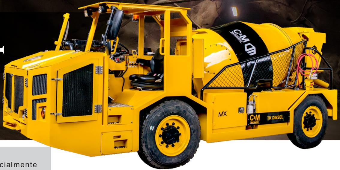
**Mx4** es un equipo especialmente diseñado para transporte subterráneo de concreto premezclado.
