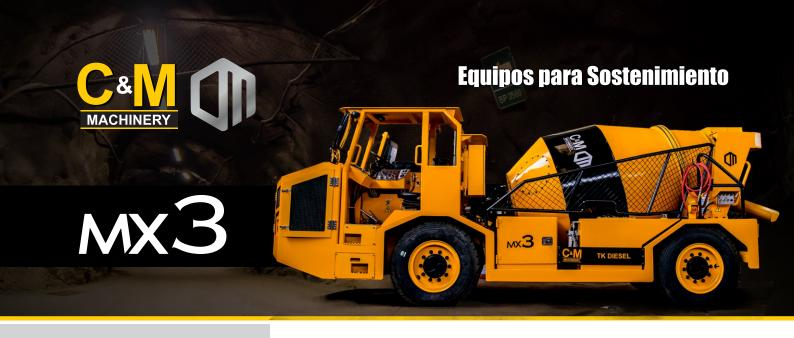
Mx3 es un equipo diseñado para transporte subterráneo de concreto premezclado. La baja altura de este equipo, permite su trabajo a mayores profundidades en mina.
