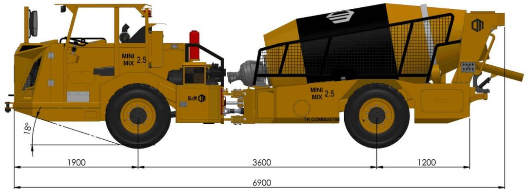
**Mini Mix 2.5** es un Mixer articulado especialmente diseñado para minas con galerías muy angostas y de poca altura. Cuenta con sistema **Hidrostático**, lo cual hace muy versátil en distintas labores.
